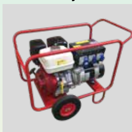
Generator i en passende størrelse, der kan forsyne stuksvejsmaskinen – se producentens vejledning angående strømkrav
